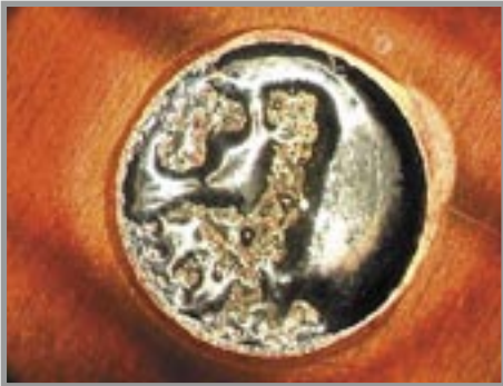
Typische Benetzung auf Cu mit konventionellem, bleifreiem Lotpulver
