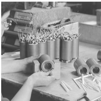
Anbringen von Deckschiebern Mise en place d'isolations d'armatures
