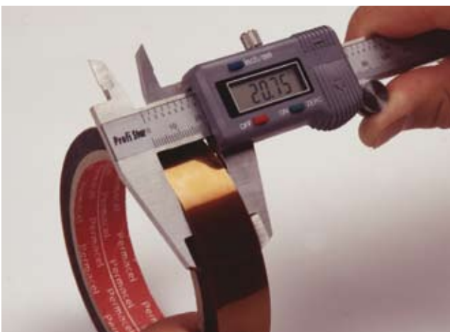
Genauigkeit von +/- 0.05 mm Une précision de +/- 0.05 mm
