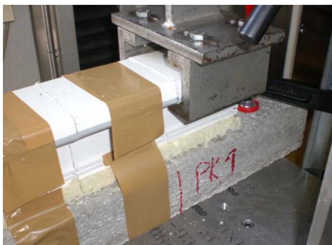
Bild 7 Prüfaufbau zum Zugversuch
