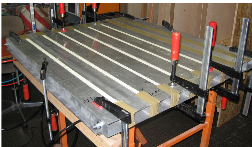
Abbildung 1 Geschäumte Fugen in Prüfvorrichtung für Längsfugen nach DIN 18542, aufgespannt auf eine luftdichte Edelstahlwanne als Prüfkammer
