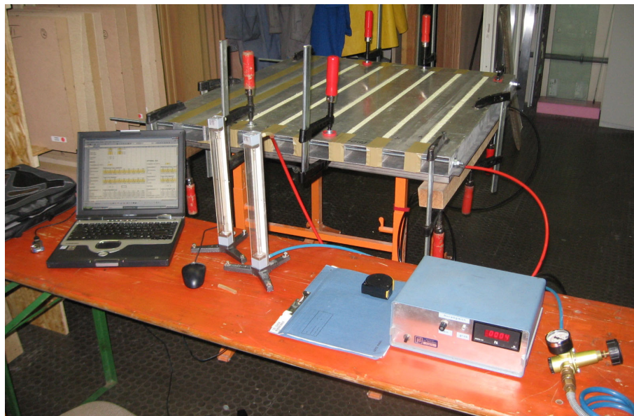
Abbildung 2 Messeinrichtung mit Durchfluss- und Druckmesseinheit.
