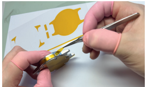
Transition entre le polissage et le satinage avec des bords nets
