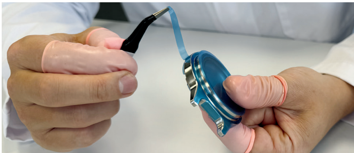
Pièces découpées sur mesure pour la protection des surfaces traitées
