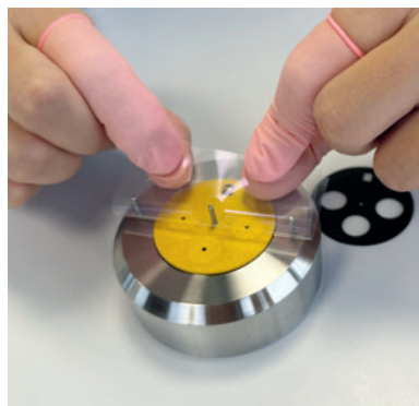
Positionnement parfait sans empiéter sur la surface adhésive
