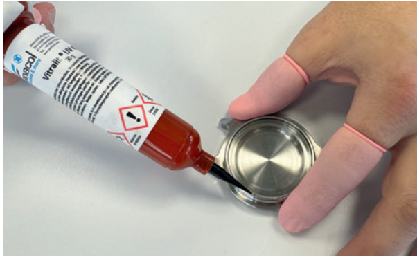
Uhrenglas mit Panacol Vitralit® in Edelstahlgehäuse kleben
