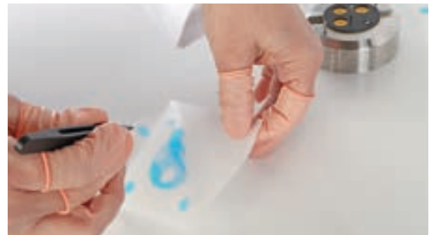
Le film de transfert avec la pièce découpée est détaché du liner.
