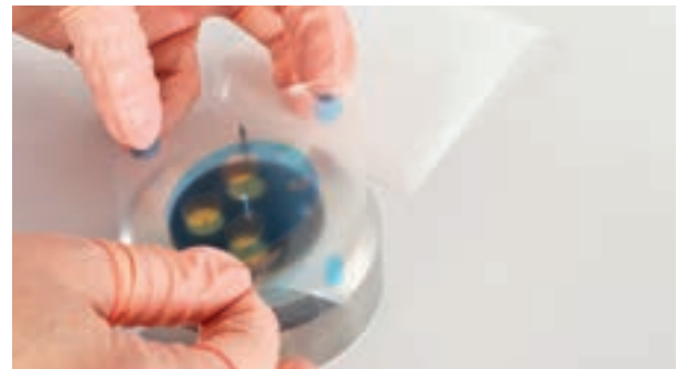
Le film de transfert peut être aligné avec précision grâce à des trous de positionnement précis.
