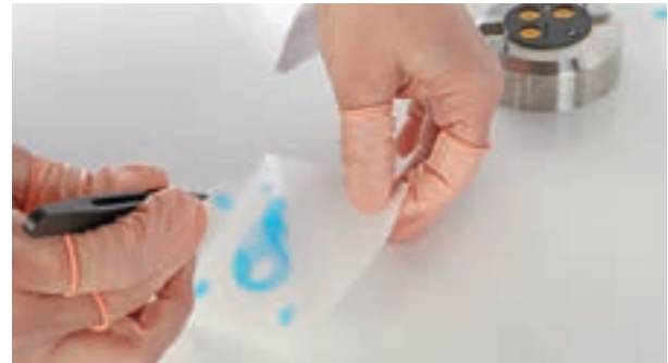
Übertragungsfolie mit Stanzteil wird vom Liner abgelöst.
