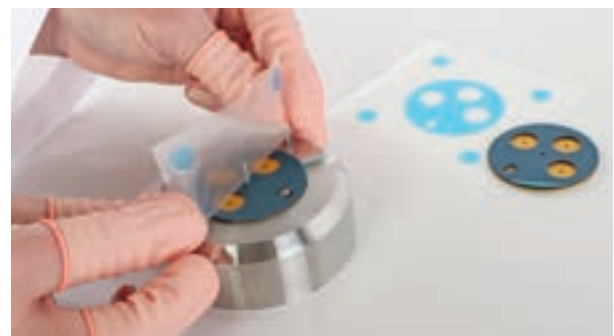
Stanzteil verbleibt auf Bauteil und Übertragungsfolie kann abgelöst werden.
